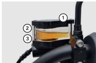
Avant : 1. Réservoir de frein avant 2. Repère de limite supérieure MAX 3. Repère de limite inférieure MIN
